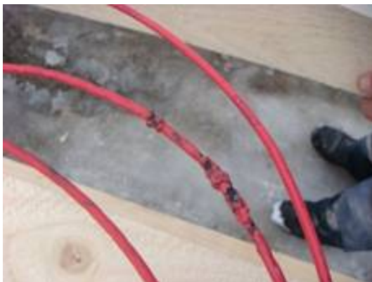
Joonis 3.7 Kõrbema läinud betooniküttekaablid jätavad betooni külma kätte.
