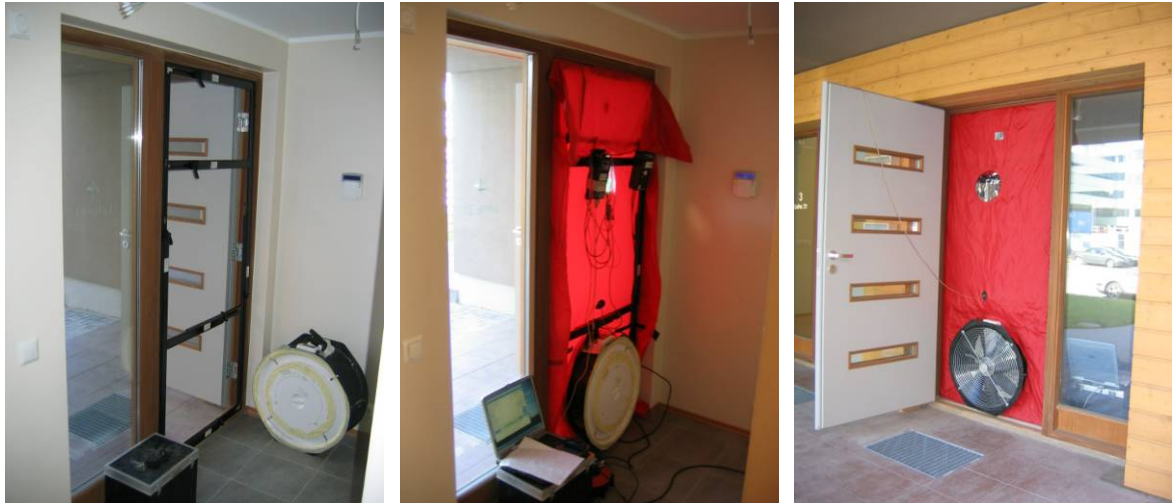
Joonis 7.1 Korteri piirete õhupidavuse mõõtepõhimõte (vasakul ülal). Õhulekke graafik: lekkeõhuvoolu sõltuvus õhurõhkude erinevusest (paremal ülal). Mõõteseade paigaldatuna korteri välisukse ette (all).
