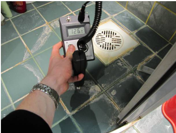
Joonis 5.44 Trappide hüdroisolatsioon oli paljudes külastatud korterites vigane ning aluspõrand märg.
