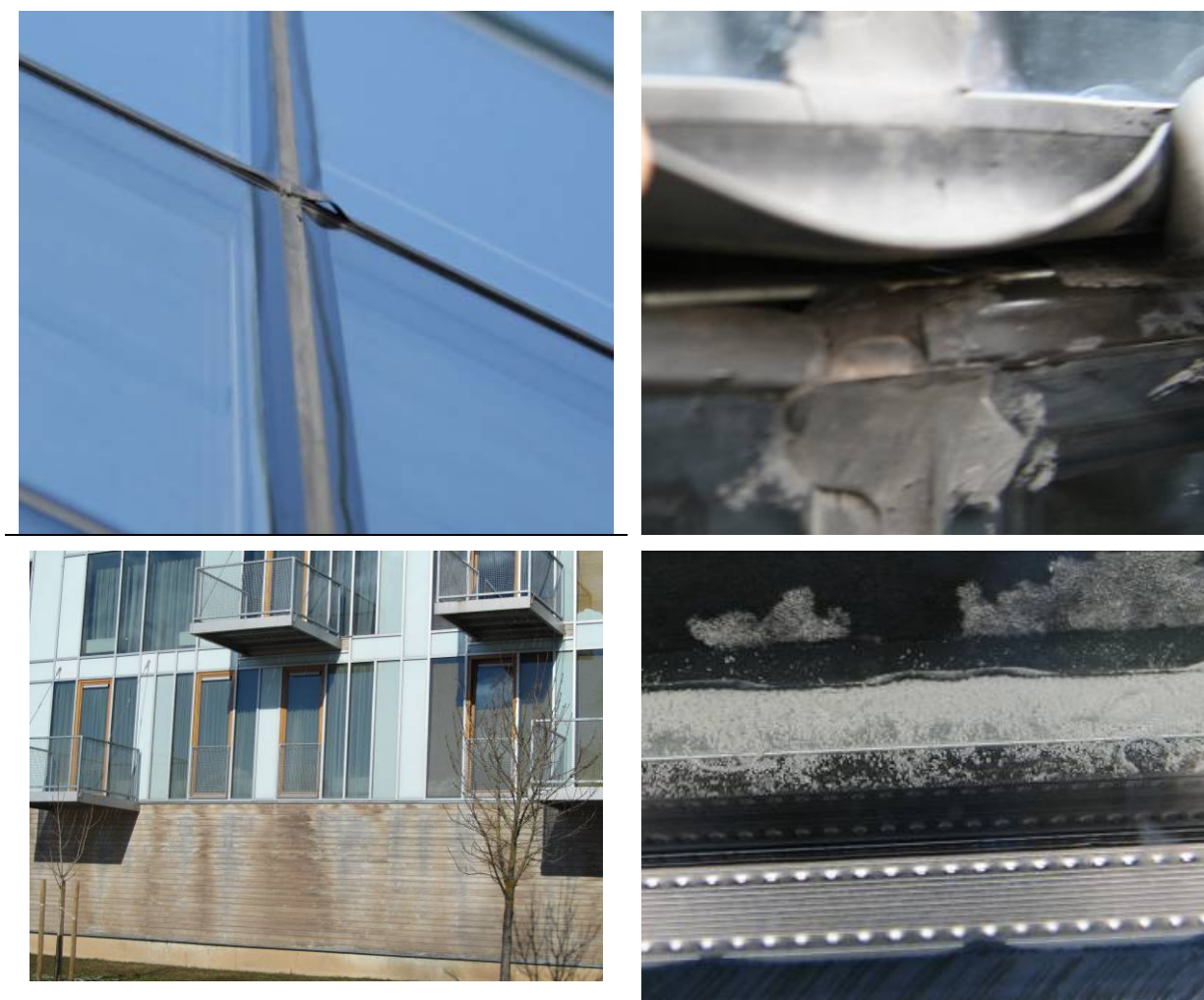
Joonis 5.27 Klaaspaketi ebaõige kasutamise tulemused: vuugikatteribad on lahti (vasakul ülal), tihti eelkõige arvestamata jäetud temperatuurimuutusest tingitud pikenemiste-lühenemiste tõttu. Vuugitäide ei täida vuuki (paremal ülal). Vesi pääseb pragudesse sisse. Paketi servade hermeetilisus on kadunud (paremal all). Klaaspaketis loksub vesi. Puuduliku lahenduse tõttu valgub klaasfassaadilt vihmavesi puitlausidele, mis on hakanud lagunema (vasakul all).
