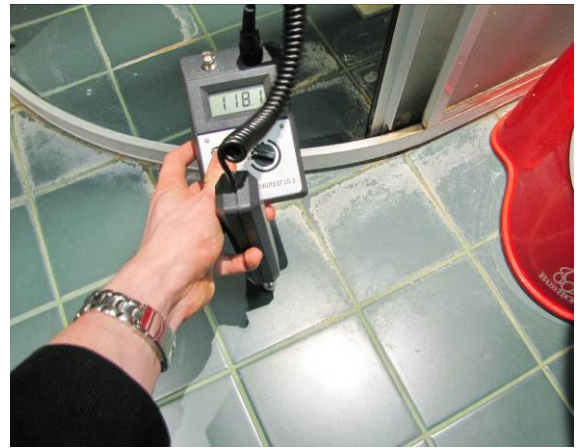
Joonis 5.44 Trappide hüdroisolatsioon oli paljudes külastatud korterites vigane ning aluspõrand märg.
